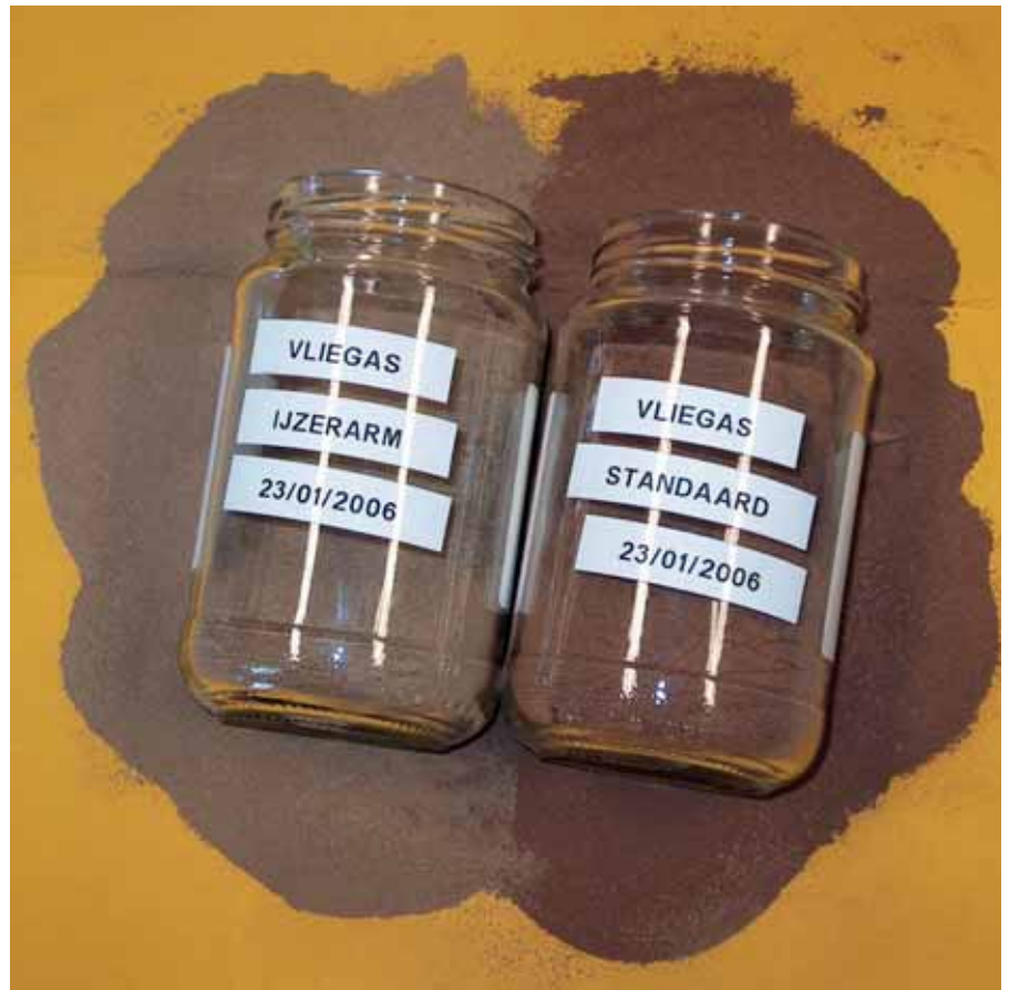
Kleurverschil tussen ijzerarme en normale as.
