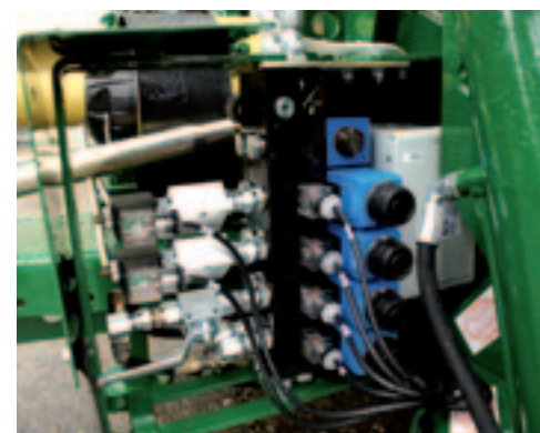
Dankzij de elektrohydraulische bediening, heb je niet meer nodig dan een dubbelwerkend ventiel.
