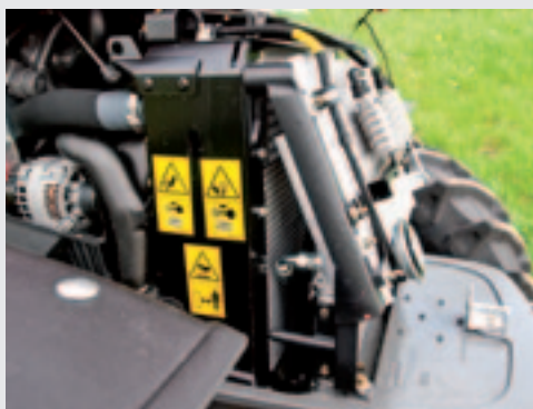
■ De viercilinder Perkins heeft plaatsgemaakt voor een driebilinder van AgcoPower.
