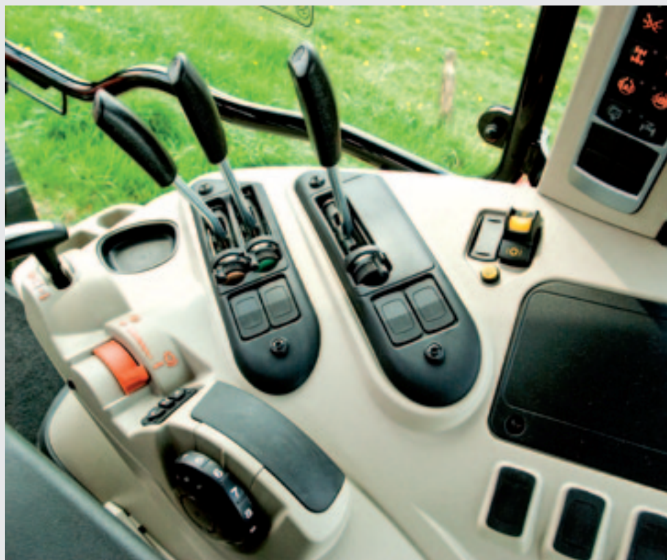
■ Het rechterzijconsole van de MF 5610. Veel bedieningsknoppen en ook de startsleutel zijn naar de rechterzij van de cabine verdwenen. Er zijn standaard twee mechanische hydraulische ventielen.
