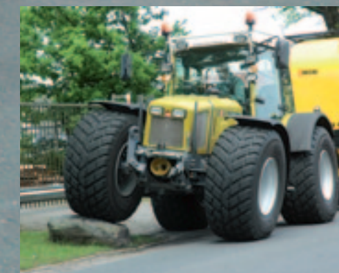
De vooras kan niet pendelen; z'n bewegingsvrijheid komt van een lengtescharnier.
