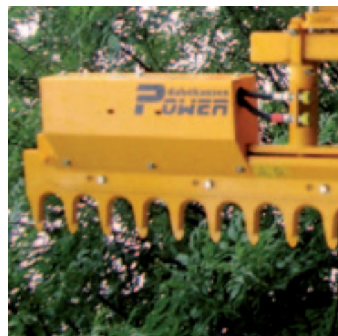
Een schaar voor takken tot 11 centimeter zoals deze van McConnell werkt nog steeds volgens het principe van een maaibalk, maar feitelijk wordt er geknipt.
