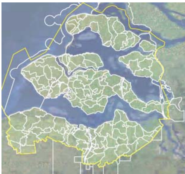
Figuur 2.1 Indeling van het beheergebied van Waterschap Scheldestromen in 127 watersysteemgebieden (afvoergebieden). De lijnvormige wateren binnen de afzonderlijke watersystemen worden geacht min of meer vergelijkbaar te zijn (Projectgroep Regionale Watersysteem Rapportage, z.j.).
