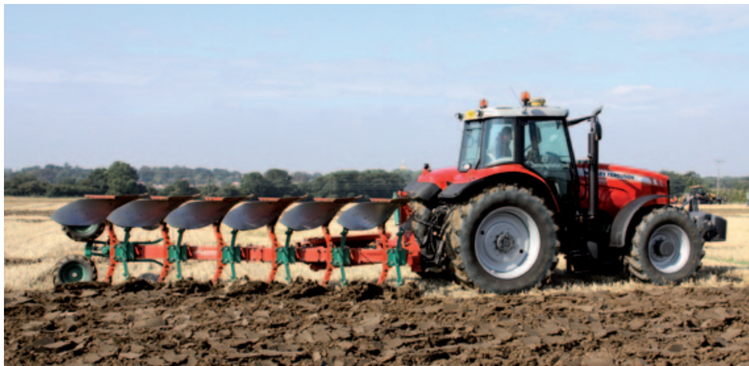
▲ De ploegbesturing bij Topcon heet TopControl en kan gebruikt worden in combinatie met het systeem 150 of 350. Iedere ploeg met hydraulische breedteverstelling kan worden aangestuurd.
