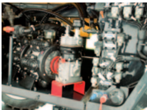
▲ De Anaconda heeft twee pompen: één om te spuiten en één om te roeren.
