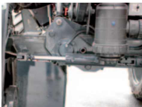
▲ De spoorbreedte is hydraulisch verstelbaar van 1,80 tot 2,25 meter.
