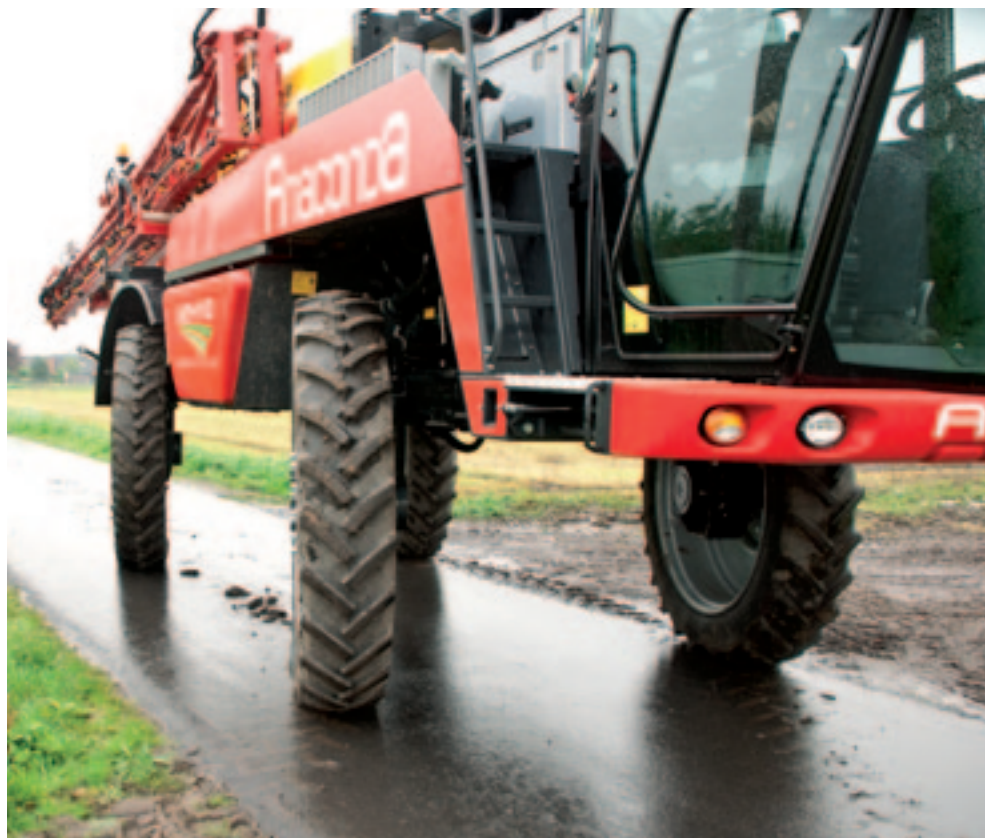
▲ De Anaconda stuurt op alle vier wielen. Maar het is ook mogelijk om in hondengang over het perceel te rijden.
