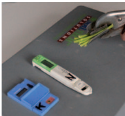
▲ Meetapparatuur voor plantsapmeting – Met een eenvoudige stikstofmeter kan snel de stikstofconcentratie van plantsap worden gemeten.
