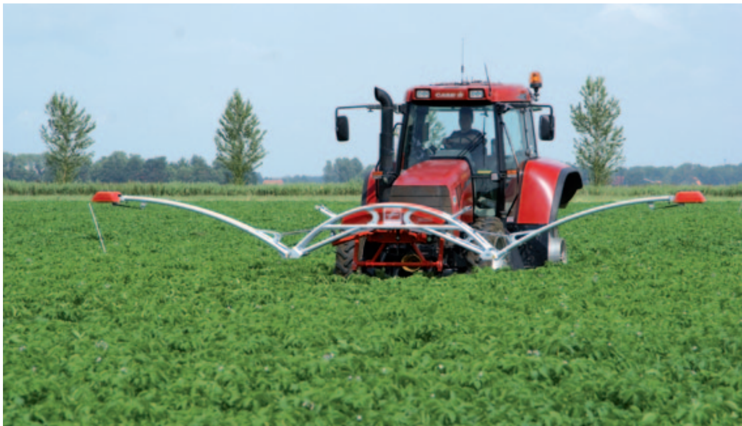
▲ Boompje met nearby sensoren. Deze sensoren meten over een smalle strook van het gewas (100 tot 300 cm) de lichtreflectie van het gewas en de metingen kunnen gecombineerd worden met een bespuiting.
