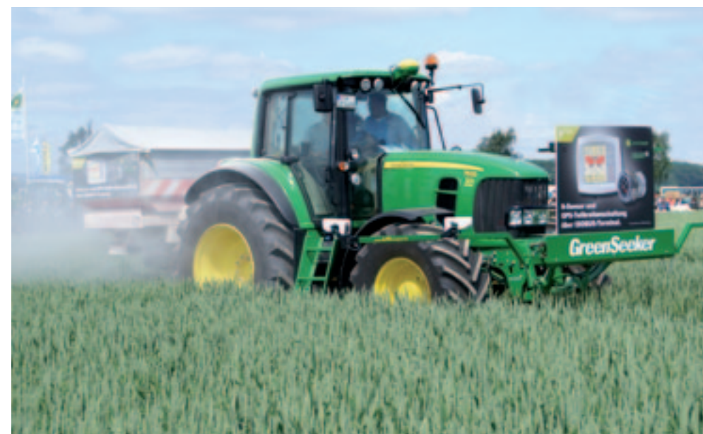
▲ De nieuwste generatie kunstmeststrooiers kan via een isobus-terminal worden aangestuurd en direct de metingen van de nearby-sensoren omzetten in een juiste stikstofgift.
