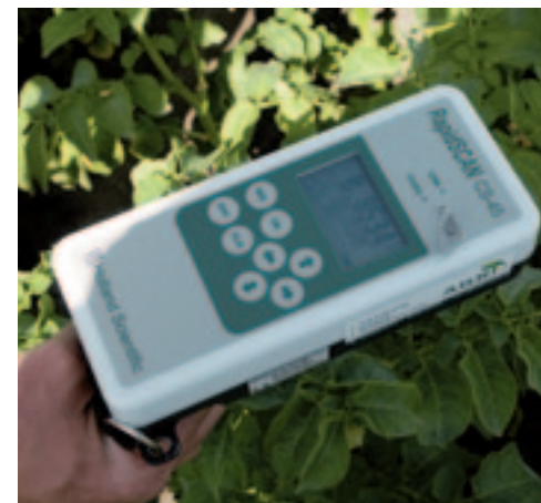
▲ Met een handsensor met een gps-module en de juiste indexen kan snel een deel van een perceel worden beoordeeld.
