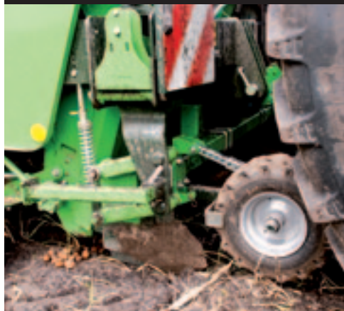
▲ Alle pootelementen hangen via een parallellogram aan één centrale garnituurbalk. Alle elementen werken daardoor even diep.
