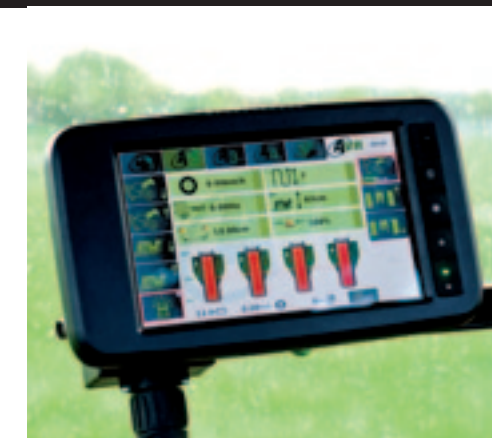
▲ De bedieningskast is dezelfde touchscreen die AVR vorig jaar introduceerde op de Spirit 9200-bunkerrooier.
