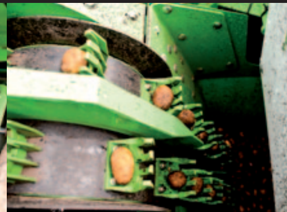
▲ Elke pootband telt 40 bekertjes. Voor verschillende potermaten kan de fabrikant verschillende inzetbekertjes leveren.
