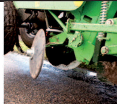
▲ De schijven zijn dicht op het pootelement gemonteerd. Zo worden praktisch alle gepote aardappelen ook toegedekt.
