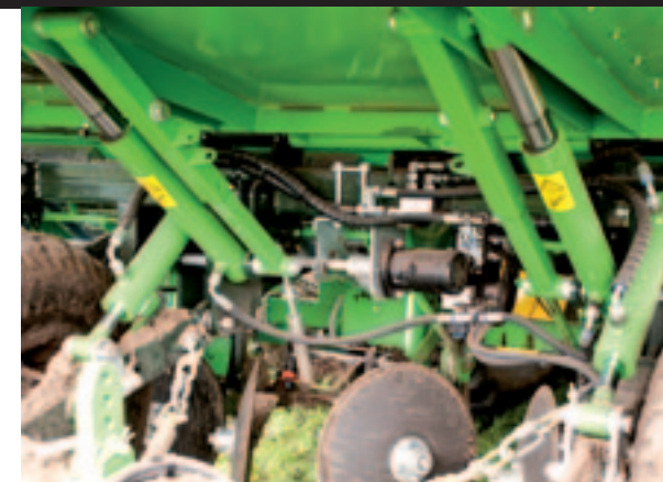
▲ De hydraulisch aangedreven variant heeft slechts één hydromotor. De pootafstand is dus voor alle elementen gelijk.
