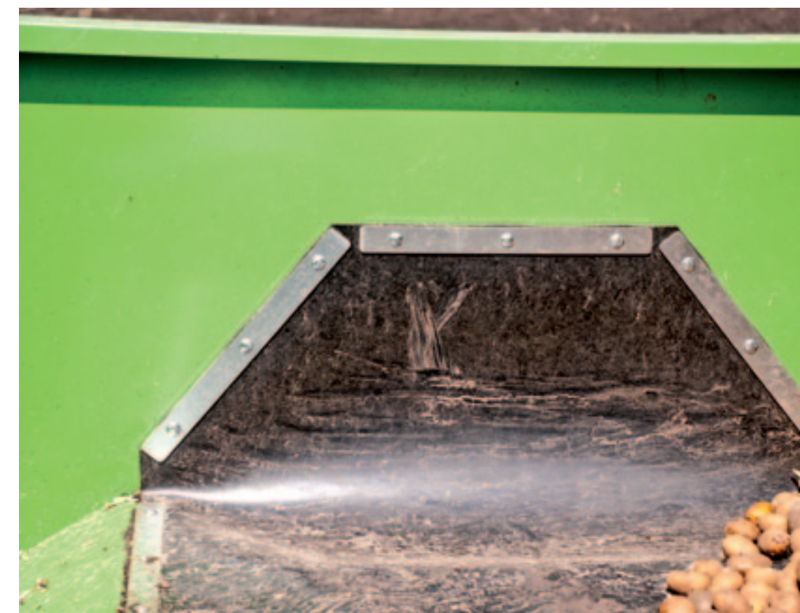
▲ Een deel van de bodem van de hydraulische bunker is niet van staal, maar van rubber. Daardoor kan de bunker tot op de banden zakken en kun direct – en dus zonder vulbandje – uit de kiepwagen vullen.
