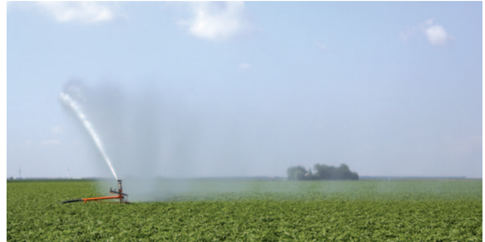
▲ Een beregeningskanon heeft een hoge waterdruk nodig om druppels te maken die fijn genoeg zijn. Dat vraagt veel vermogen.
