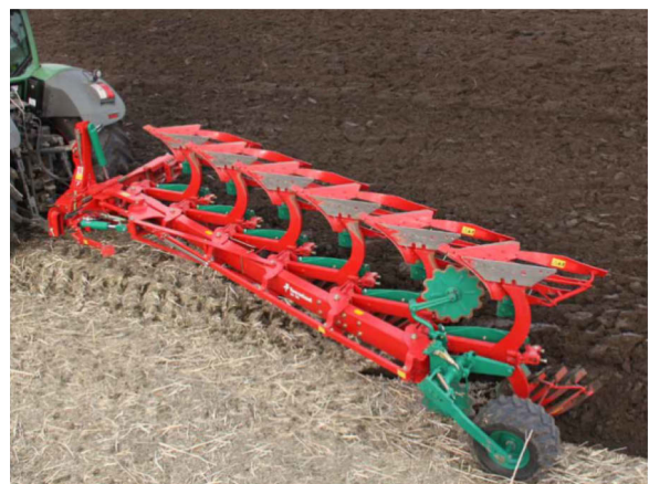
Figuur 4. Vierschaar trekker-ploeg combinatie uit 1980 (links) en een 6 schaar combinatie 2010 waarmee zowel door de voor als bovenover geploegd kan worden (rechts).
