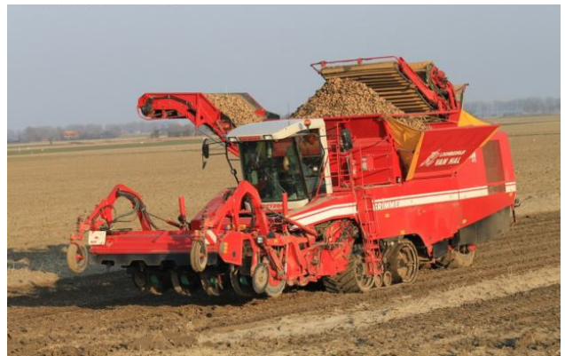
Figuur 10. Typerende aardappelrooiers voor 1980 (boven); tweerijige bunkerrooier met een bunkerinhoud van 4 ton (links) en een tweerijige wagenrooier (rechts). Typerende aardappelrooiers voor 2010 (onder): tweerijige bunkerrooier met een bunkerinhoud van 8 ton (links) en een vierrijige zelfrijdende bunkerrooier met een bunkerinhoud van 15 ton.
