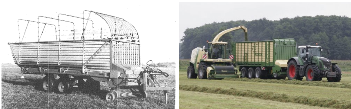
Figuur 6. Topsegment machines voor transport bij de voerderwinning: in 1980 een opraapwagen met ca. 8 ton laadvermogen (links) en in 2010 een tridemas dubbeldoelwagen met ongeveer 21 ton laadvermogen (rechts).
