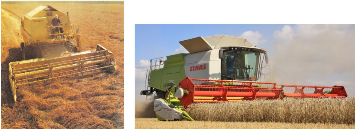
Figuur 9. Typerende maaidorser uit het topsegment machines voor 1980 met een 5,2 maaibord en 6300 liter graantank (links) en een maaidorser typerend voor 2010 (rechts), met 9,1 m maaibord en 11500 liter graantank.
