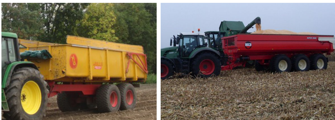
Figuur 5. Transport van akkerbouwproducten met een 16 tons tandemas kipwagen in 1980 (links) en een 25 tot 30 tons tridemass kipwagen in 2010 (rechts).
