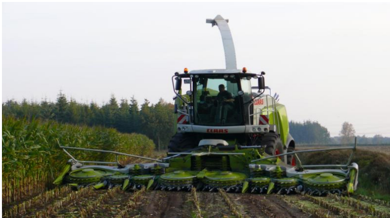
Figuur 8. Veldhakselaar met vierrijig maïsvoorzetstuk (boven-links) en een hakselaar met bunker (boven-rechts), typerend voor het topsegment machines in 1980, en een veldhakselaar met 10 rijig maïsvoorzetstuk, typerend voor het topsegment in 2010 (onder).
