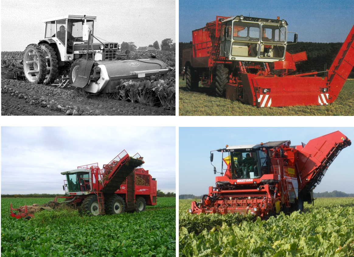
Figuur 11. Typerende bietenrooimachines: een zesrijige bietenrooier voor en achter aangebouwd aan een trekker (linksboven) en een 6 rijige zelfrijdende bunkerrooier met een bunkerinhoud van 10 ton (rechtsboven) voor 1980. Voor 2010 een 6 rijige zelfrijdende bietenrooier met 3 assen en 28 ton bunkerinhoud (linksonder) en een 6 rijige zelfrijdende bunkerrooier op rubber rupsen met een bunkerinhoud van 22 ton (rechtsonder).
