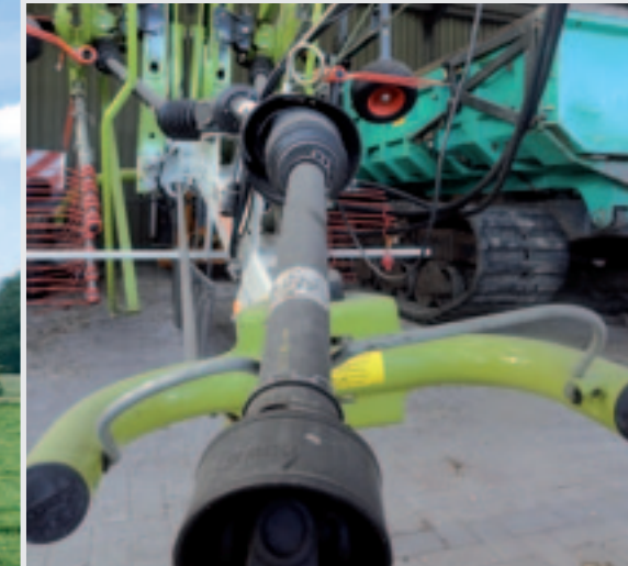
De machine wordt bevestigd aan de onderste hefarmen. Zo is het mogelijk tot een stuurhoek van 80 graden te sturen.
