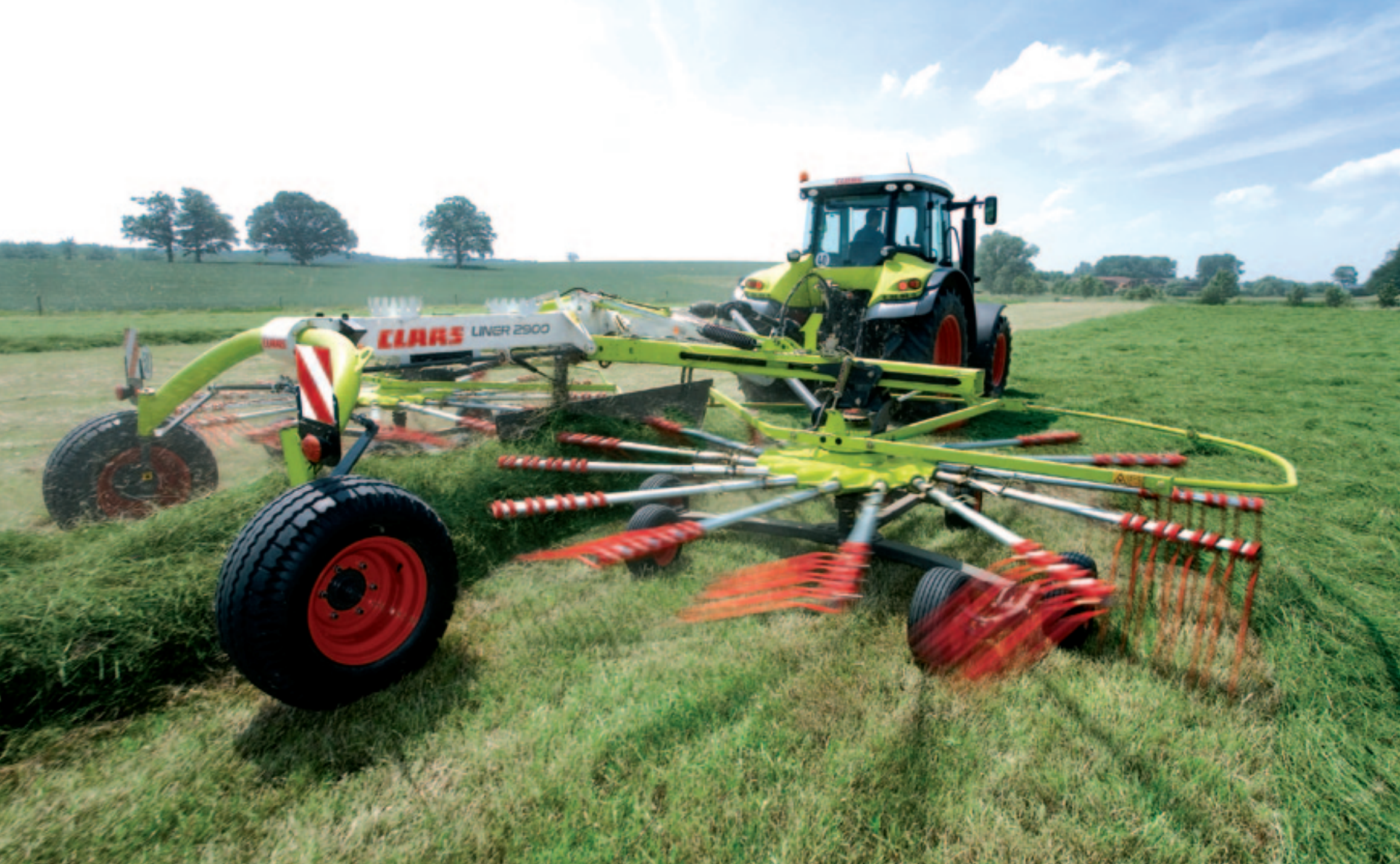
De machine wordt bevestigd aan de onderste hefarmen. Zo is het mogelijk tot een stuurhoek van 80 graden te sturen.
