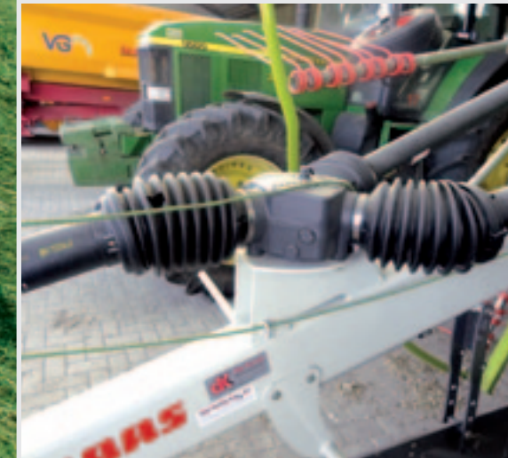
De aandrijflijn loopt Y-vormig aan de bovenkant over het frame. Hierdoor zijn er geen problemen tijdens het opklappen.
