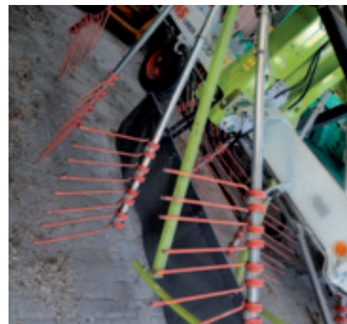
Elke rotor heeft 14, dubbelgelagerde tandarmen. Aan elke arm zitten vier dubbele tanden van 9,5 mm dik.
