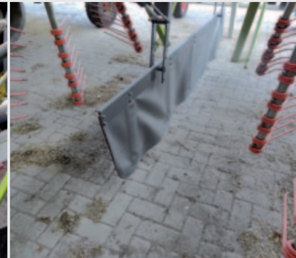
Het zwaddeek is hydraulisch opklapbaar. Dat gaat automatisch als de machine in de transportstand wordt gezet.
