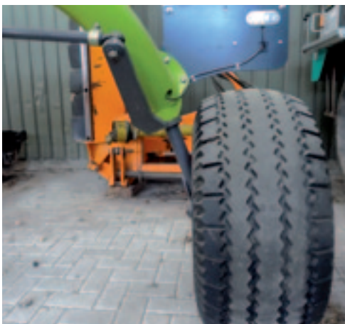
De Liner 2900 heeft twee grote, actief gestuurde transportwielen. De besturing staat in een hoek om zo min mogelijk wrijving te creëren.
