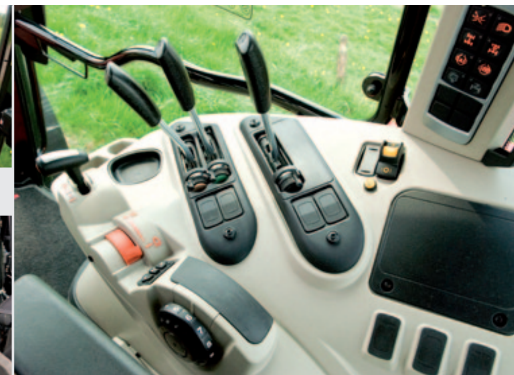
Het rechterzijconsole van de MF 5610. Veel bedieningsknoppen en ook de startsleutel zijn naar de rechterzij van de cabine verdwenen. Er zijn standaard twee mechanische hydraulische ventielen. Een derde is een optie.
