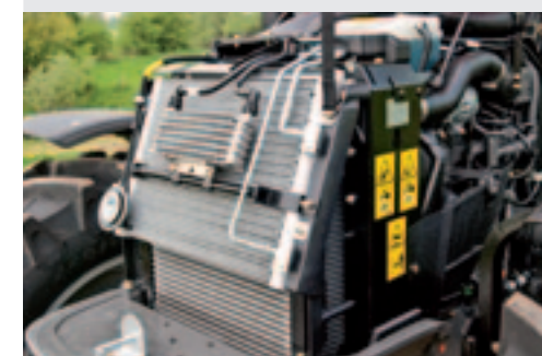
De viercilinder Perkins heeft plaatsgemaakt voor een driecilinder van AgcoPower.
