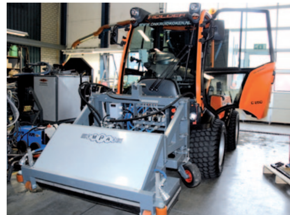
De onkruidkoker kan eenvoudig worden losgekoppeld van de werktuigdrager. Op die manier kan de werktuigdrager ook nog voor andere werkzaamheden worden ingezet.
