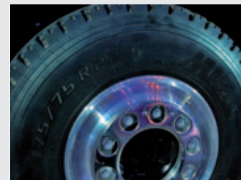
Mitas, een zusterbedrijf van Continental, ontwikkelde speciaal voor de Unimog een nieuwe band met maat 175/75 R22.5.
