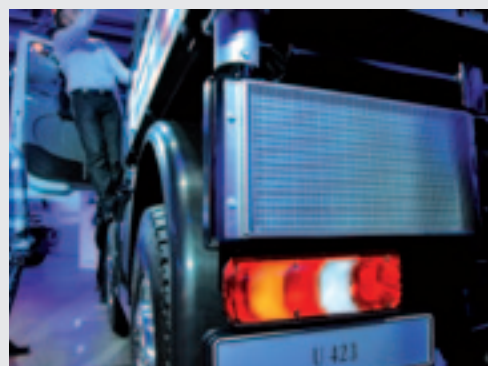
Met een hydrostatische aandrijving en een EGR-koeler, moest Mercedes-Benz drastisch op zoek naar plaats voor meer koelers.
