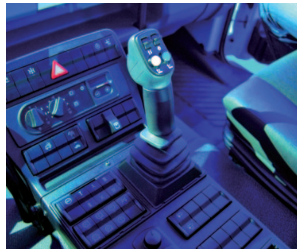
De middenconsole is volledig vernieuwd. Dat geldt overigens voor het hele interieur. De joystick kan desgewenst op een andere plaat in de console geplaatst worden en optioneel in de armleuning van de bestuurdersstoel. Alle knoppen zijn multifunctioneel en dus uitwisselbaar.
