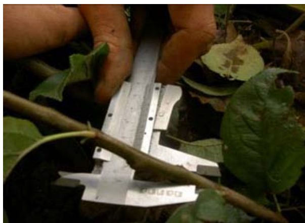
Het meten van de dikte van de onderstammen is met een schuifmaat uitgevoerd.
