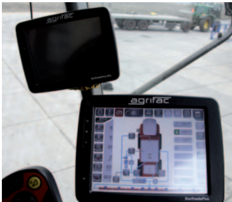
▲ De EcoTronicPlus wordt als goed doordacht en gebruiksvriendelijk ervaren. Het tweede scherm is voor de sectiebesturing op gps.
