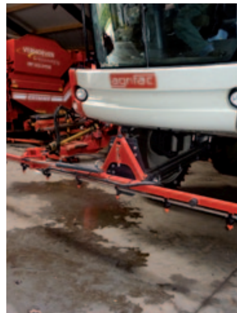
▲ Marcel Verhoeven liet een spuitboom voorop monteren voor het bespuiten van kopakkers.
