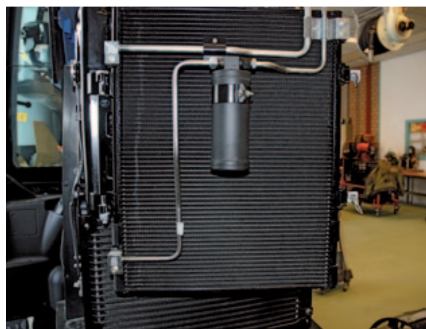
De condensor koelt het gas af en het koelmiddel wordt weer vloeibaar.
