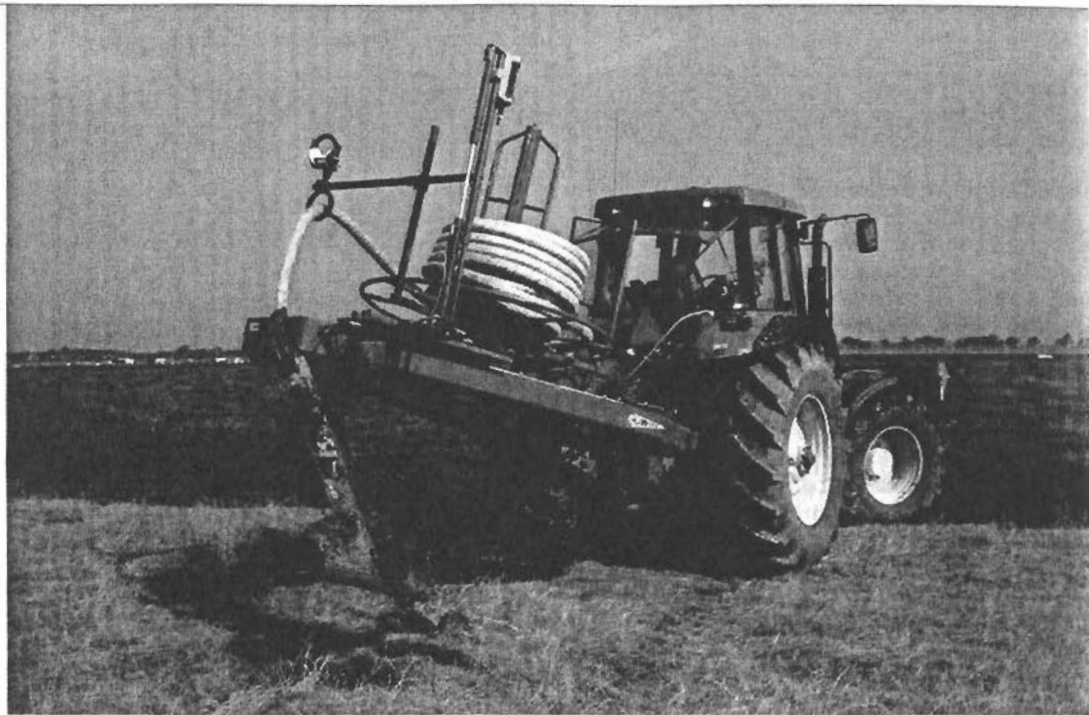
Met een mes dat schuin door de grond snijdt kan eenvoudig een drain gelegd worden. Loonbedrijf De Vlijt laat nu een nieuwe, verbeterde machine bouwen.
