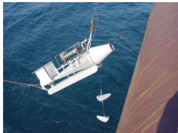
De plankton torpedo wordt gebruikt voor het vissen om makreleieren,
