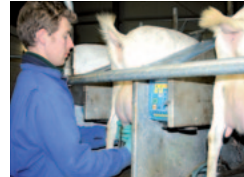
De draaimelkstel met melkmeter heeft een capaciteit van circa 750 geiten per uur.
