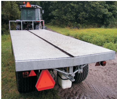
Wagen met V-bak voorkomt lekverliezen bij het vervoer van ontsmette bollen
