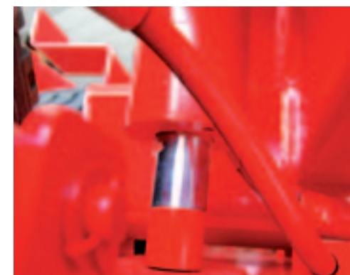
Door de pendel te blokkeren met een cilinder, verplaatst je het zwaartepunt naar de achteras.
