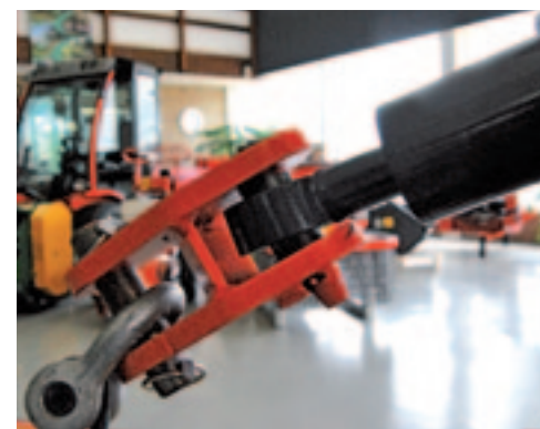
Bigab's hebben standaard een trekcilinder die voorkomt dat de carrier de trekker optilt.
