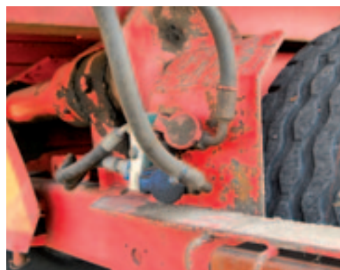
Om containers te wisselen, moet je eventuele hydraulische functies loskoppelen.
