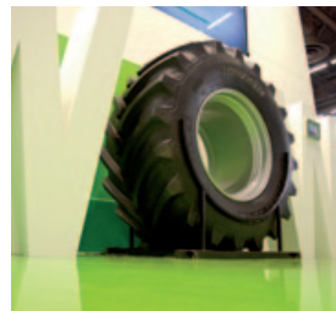
▲ Bandenfabrikant BKT voegt een paar nieuwe maten aan het programma toe. Een daarvan is de IF900/60R38 voor trekkers boven 200 kW. Een band uit de AgrimaxForce-serie voldoet aan de Increased Flexion-eisen. Het karkas van de band is zo flexibel dat het ook hoge gewichten kan dragen bij lage druk of bij hoge snelheid. In dit geval kan de band bij 65 km/h nog steeds 9.000 kg dragen. Behalve de 900 mm brede band, voegt BKT ook de IF710/60R30 aan deze AgrimaxForce-serie toe.
