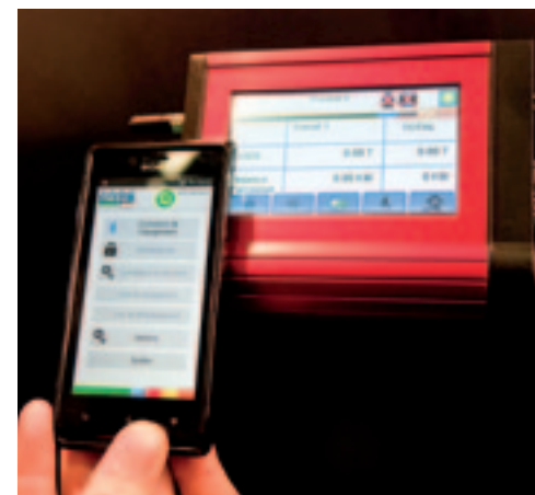
▲ Het Franse Agtronix kan de gegevens van het weegstelsel, dat op kippers is te monteren, op afstand uitlezen. Drie weegscellen sturen hun gegevens via een draad naar een beeldschermje in de trekkercabine. Die monitor is via een bluetooth-dongle met een telefoon benaderbaar. Je kunt de gegevens dus ook buiten de trekkercabine, met een Android-telefoon, aflezen. Vervolgens kun je de weeggegevens per e-mail of sms verzenden. Het weegstelsel kost 4.500 euro.
