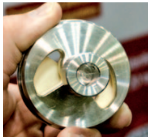
▲ Het DynamicFluid 4-systeem van spuitfabrikant Hardi werd eind vorig jaar op de Deense vakbeurs Agromek al onderscheiden met een innovatieaward. Hart van het systeem is de flowregelaar met een keramische klep. Deze reageert razendsnel op zaken die van invloed zijn op de gewenste spuitvloei-stof (lager toeren-tal van de pomp, een lagere rijsnelheid of afsluiting van secties). Vooral na het keren op de kopakker spuit je daardoor meteen weer de juiste hoeveelheid vloeistof.
