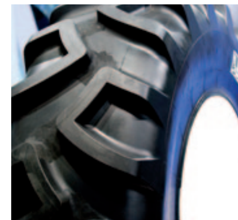
▲ Michelin bracht een trekkerband met sterk afwijkend profiel naar de Sima: twee nokken zijn met elkaar verbonden door een nok in de lengterichting. De fabrikant zoekt met het prototype namelijk naar een band die het op de weg langer volhoudt en comfortabeler is, maar waarmee je in het veld ook niet meteen blijft steken. Of de trekkerband inderdaad comfortabeler is, lijkt een beetje de vraag. Midden opband ontbreekt namelijk een aaneengesloten nokkenlijn.
