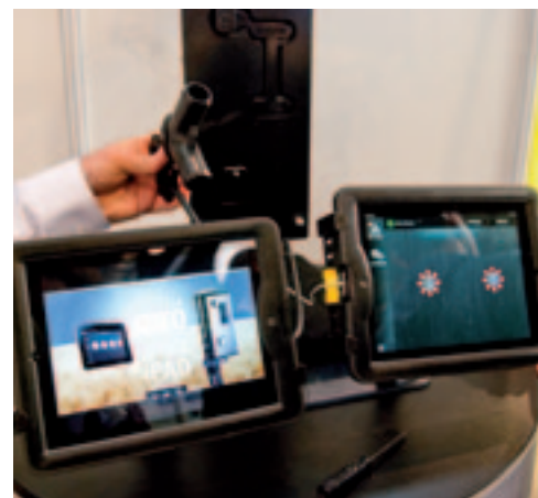
▲ Appareo bedacht dat je met een microfoon-tje aan het eind van een slangetje kunt horen of een zaadslang van een pneumatische zaai-machine verstopt is. Software registreert het geluid dat het zaad tegen een metalen plaat maakt. Via wifi wordt dat doorgegeven aan de iPad in de trekker. Valt een signaal weg omdat de buis is verstopt? Dan is op de iPad te zien welk buis dicht zit. Voordeel? Doordat het geluid via slangetjes wordt doorgegeven, zijn minder kwetsbare kabels nodig.
