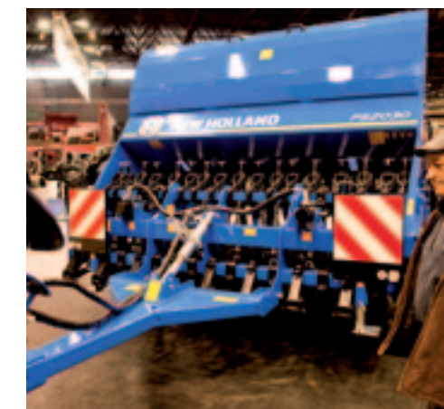
▲ New Holland verwacht dat er ook in Europa een grote markt is voor het zaaien zonder uitvoerige grondbewerking. Daarom werkt het samen met het Braziliaanse Semeato, waarvan het zaaimachines betreft. Voor de Europese markt toonde New Holland twee zaaimachines. Een ervan is de PS2030, een 17-rijige machine met een werkbreedte van drie meter. Deze is geschikt voor de individuele akkerbouwer. Hij heeft een tank-inhoud van 1.600 liter en 17 schijfkouters op 17,5 cm van elkaar.
