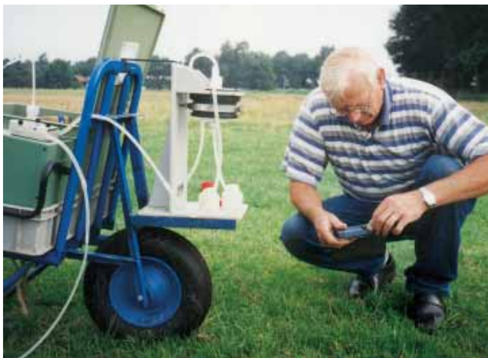
In het veld wordt de Nitratecheck gebruikt om het nitraatgehalte van grondwater te meten.
