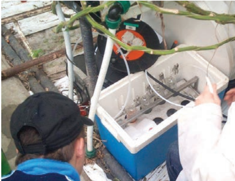
Figuur 7. Meetopstelling calciumchloride in lucht uit de slurf.
