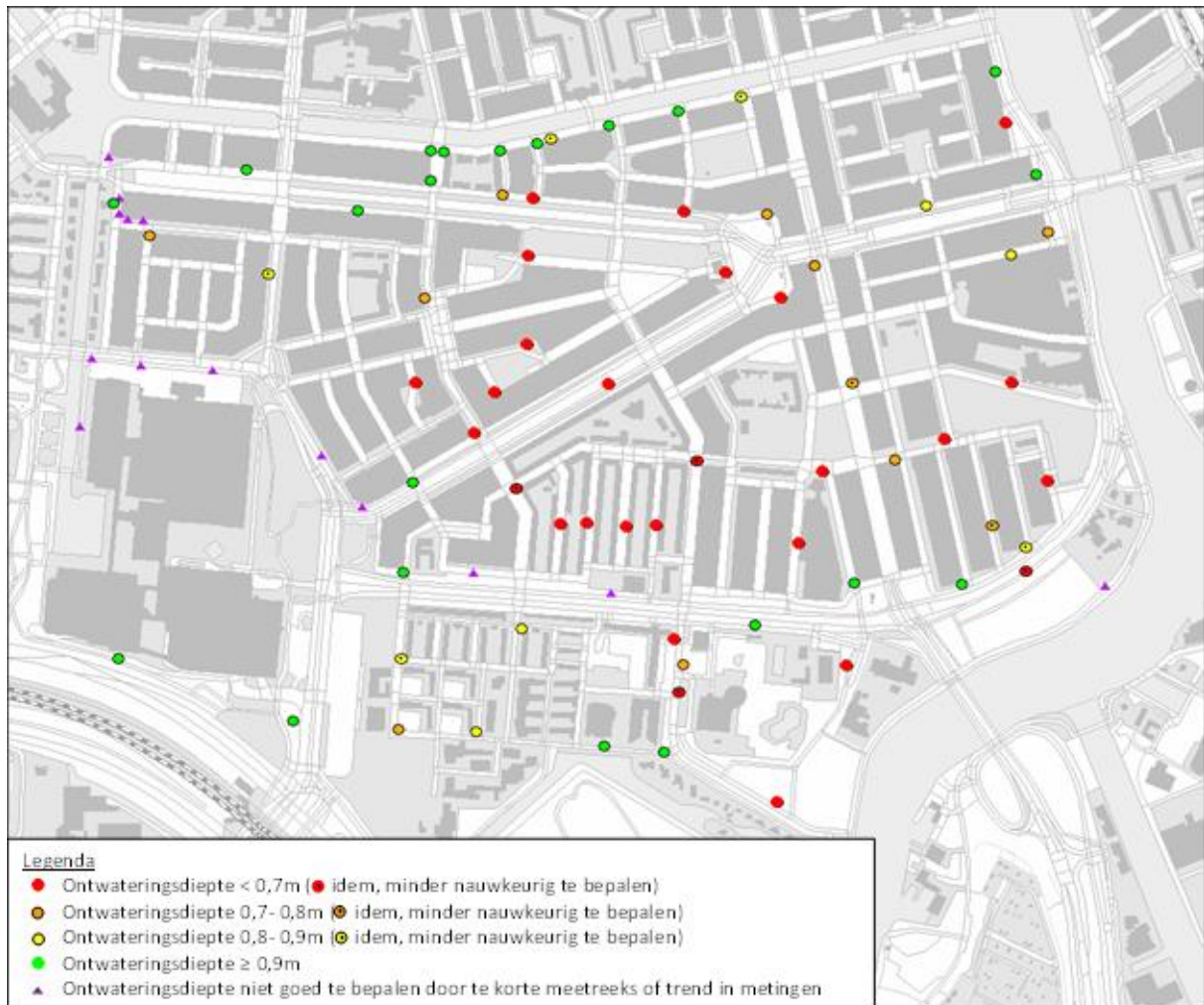
Figuur 6. Variatie in ontwateringsdiepte (de grondwaterstand onder het oppervlak) op meetpunten binnen de Rivierenwijk (bron: Waternet). De figuur toont de variatie in hoge en lagere grondwaterstanden binnen de wijk. Deze variatie vraagt om maatwerk op relatief kleine schaal.
