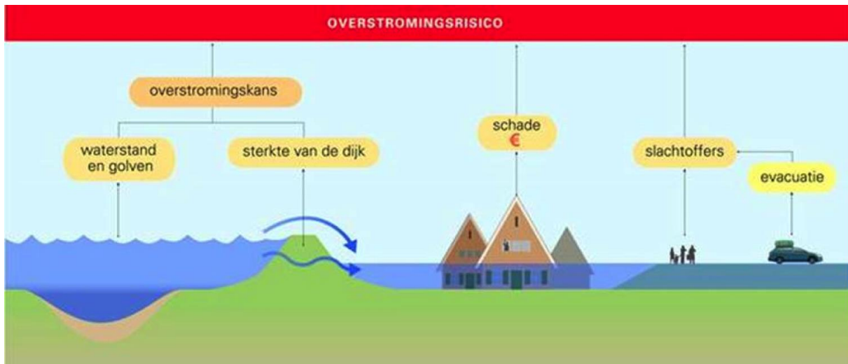
Figuur 3. factoren die het overstromingsrisico bepalen. Door middel van maatregelen in alle drie lagen kan het risico worden beïnvloed
