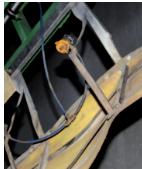
▲ De strips waren vroeger van verenstaal en tegenwoordig van thermoplastisch carbon.
