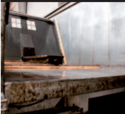
▲ Bij het lossen van de lading schuift eerst de bodem en vervolgens de voorwand naar achter.
