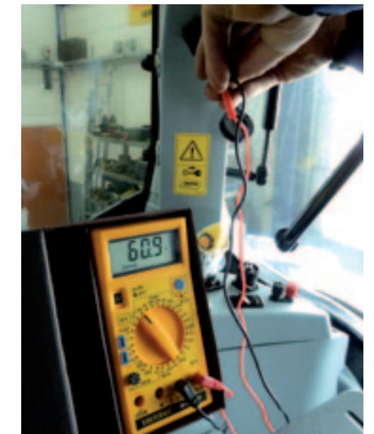
▲ Een meting van de weerstand over can-hi en can-lo.
