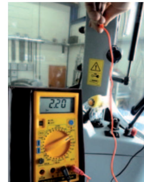
▲ Een meting van de can-lo-spanning.
