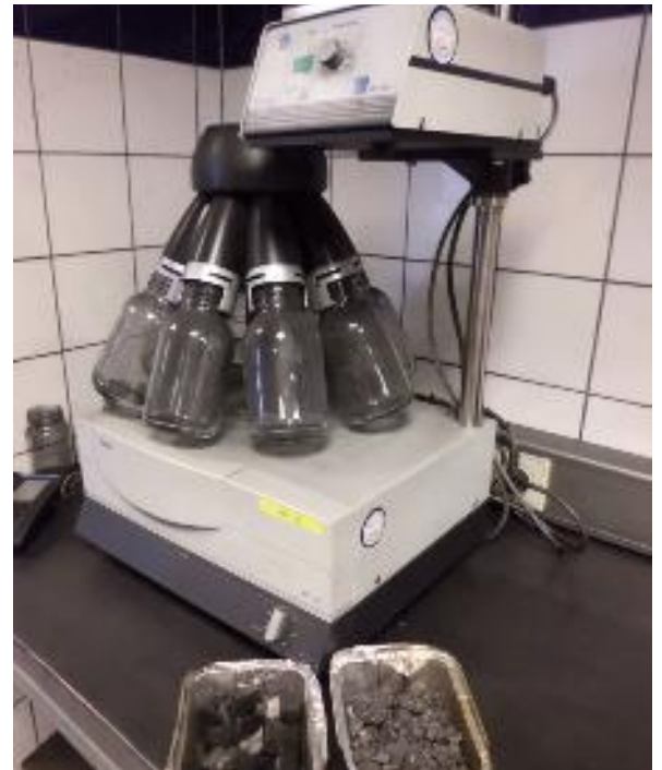
Labinstallatie voor onderzoek naar cokes. Op voorgrond links bio-cokes, rechts reguliere petcokes.
