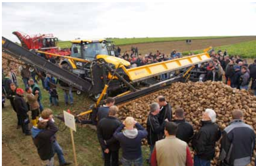
De firma Brettmeister presenteerde een zogenaamde mini-muis. Die past op een flinke trekker en kan overal uit de voeten. Hij is in elk geval een stuk goedkoper dan de bestaande muizen. Bij Beet Europe wist deze maar 1,3 procent van de tarra te verwijderen. Het slechtste resultaat van de 4 geteste laders. Bij de andere 3 was dit minimaal 2 procent of meer.
