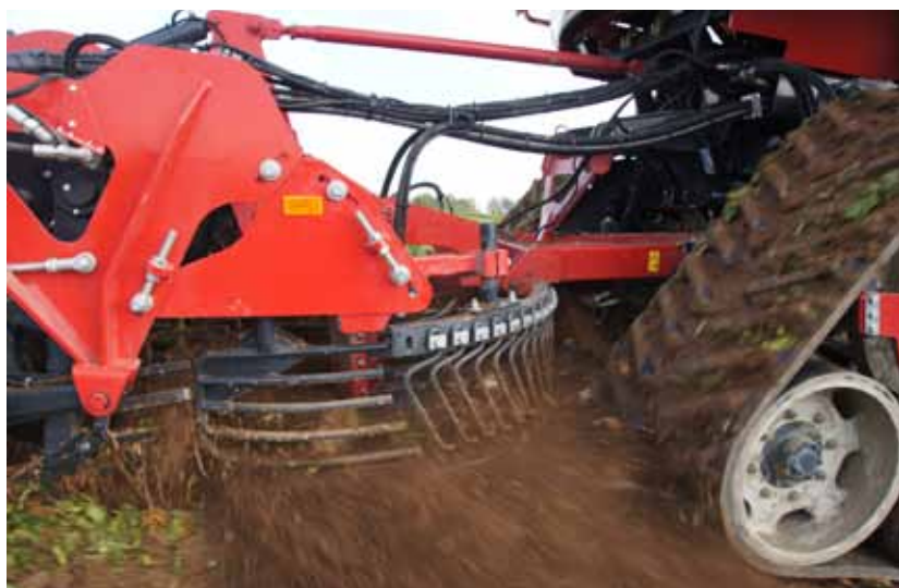
Agrifac rooide met de nieuwe Quatro. Deze machine had geen rollenbed, maar gewoon zonnen achter de rooiunit. Deze draaiden met hoge toerentallen en dus was de puntbreuk in de meting bovengemiddeld.
