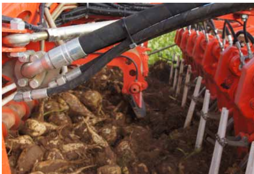
De reinigingsrollen achter de rooischaren lopen op de negenrijige rooier van Holmer bij de hoge opbrengsten zo vol, dat er weinig van het reinigende effect over blijft.
