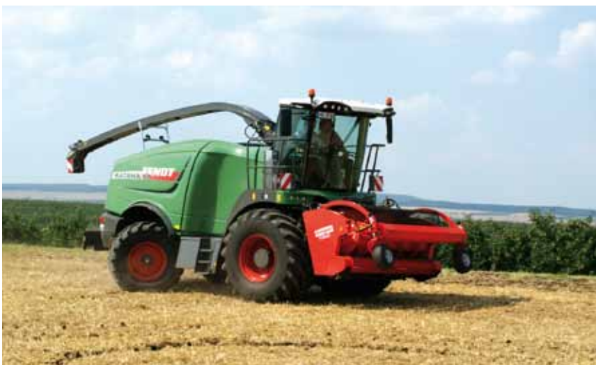
Op de Fendt Katana 65-hakselaar passen pick-ups voor gras met breedtes van 3,00 en 4,00 meter en maïsbekken van 3,75 en 3,90 meter uit de 300Plus-serie.
