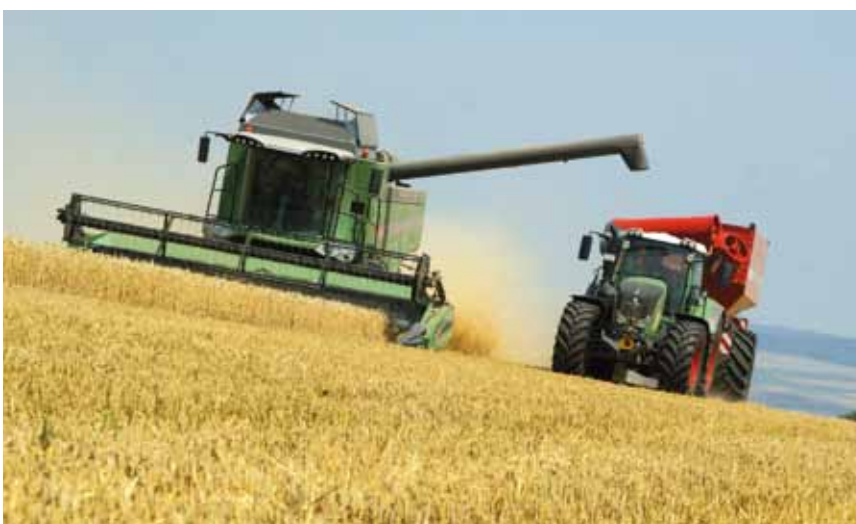
De C-serie-maaidorsers van Fendt kent u ook onder de merknaam Massey Ferguson en in de kleur rood. De nieuwe 5275C en 6335C zijn er standaard met starre as of met de PL-wielophanging met niveaustelling, waardoor je de machine zoveel mogelijk waterpas kunt laten werken. In de 5275C ligt een 203 kW (276 pk) Agco Sisu Power-zescilinder, de 6335C is uitgerust met een Agco Sisu Power-zescilinder die 265 kW (360 pk) levert. De nieuwe Skyline-cabine kenmerkt zich door veel binnenruimte, gelamineerde, geluiddempende beglazing, standaard een airco, elektrisch verstelbare groothoekspiegels en prima werkverlichting rondom.
