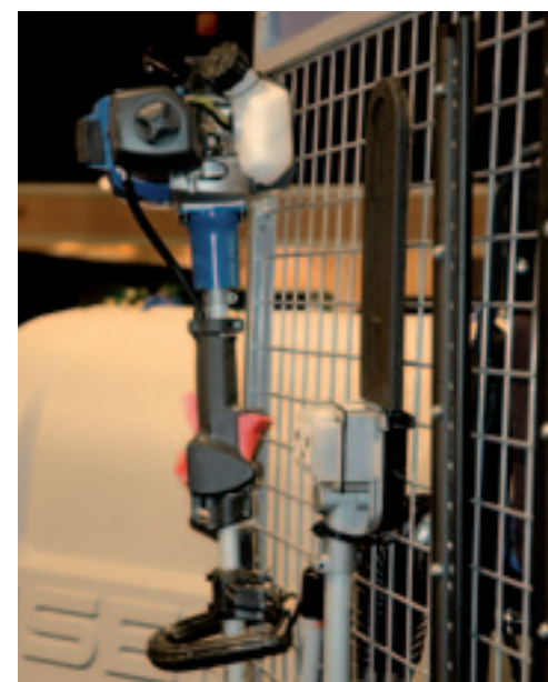
De Iseki IMAT27S Multi-tool vormt de basis voor twee heggenscharen, een kantensnijder met draadkop en/of een kleine motorzaag. Deze vier 'tools' zijn met een snelkoppeling vast te klikken op de Multi-tool. Die kost 425 euro inclusief btw. De draadkop kost 91 euro; de kettingzaag en de heggenschaar zitten op 370 euro. De 26 cm 3 Kawasaki-benzinemotor levert 0,9 kW bij 7.500 toeren.
