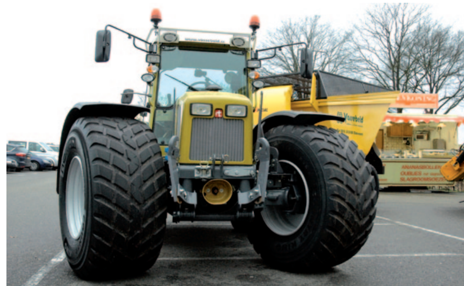
Deze vierwielbestuurde Rigitrac van Vosseveld Oldenzaal heeft Country King's van Nokian in de maat 620/60R26,5. De Rigitrac heeft een lengtescharnier en houdt daardoor beide assen en ook de werktuigen in de hef voor en achter evenwichtig aan de grond.
