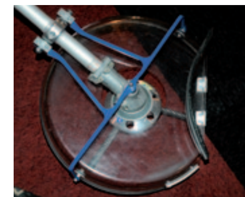
Een bosmaaier (motorzeis is eigenlijk een beter woord) moet ook op verharding veilig werken, zonder het risico dat het apparaat steentjes of puinresten wegslaat. De nieuwe Weed-Go kunststof beschermkap van Weber, die via Stierman op de markt komt, valt vooral op door zijn lage gewicht en het goede zicht dat hij biedt op het werk. De montagebeugel is leverbaar voor vijf steel-diameters (26, 28, 30, 32 en 36 mm). Inclusief de montagedelen kost de kap 207 euro excl. btw. Inclusief een onkruidborstel zit de prijs op 382 euro. Een deel van de rand van de kap is opklapbaar, waardoor er ook bij stoepanden, tuinmuurjes en schuttingen goed benaderbaar zijn en er streeploos te werken valt.
