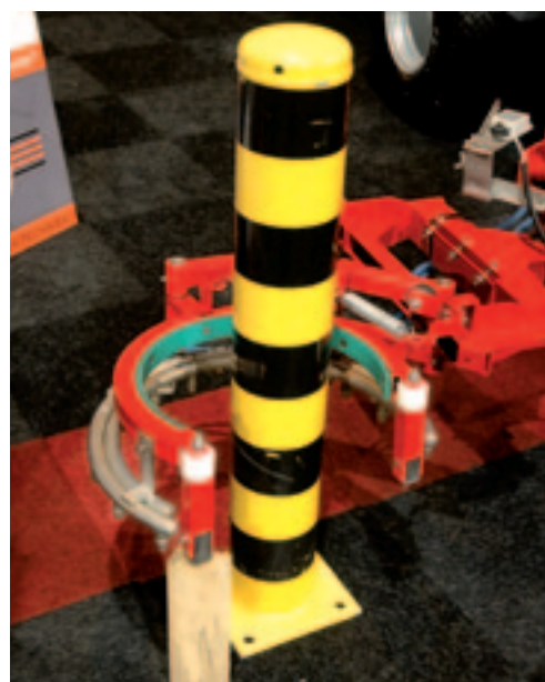
De Boemerang van Empas spuit rondom palen en andere obstakels met een diameter tot 35 cm. De U-vormige constructie draait in het voorbijgaan om de paal heen, waardoor de hele omtrek wordt behandeld. Door de 'platte' constructie kan de Boemerang ook terecht onder bankjes en vuilnisbakken. Compleet met de hydraulische arm zit de prijs rond de 18.000 euro.
