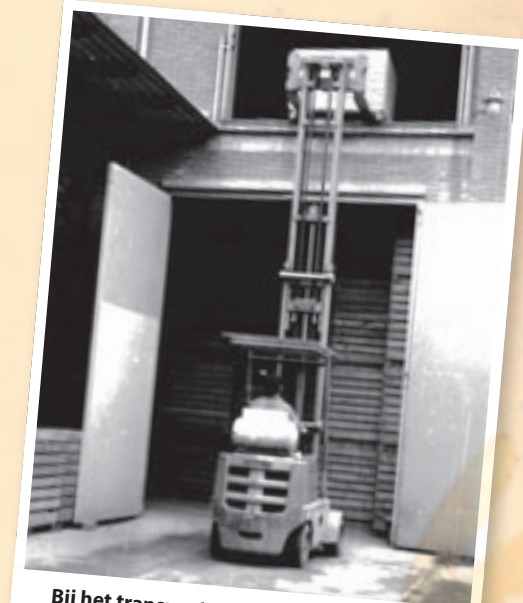
Bij het transport van aardappels in kisten krijgt de vorkheftruck een steeds belangrijkere rol. Een volle kuubs kist met een gewicht van 750 kg wordt zonder probleem op 5 meter hoogte weggezet.
