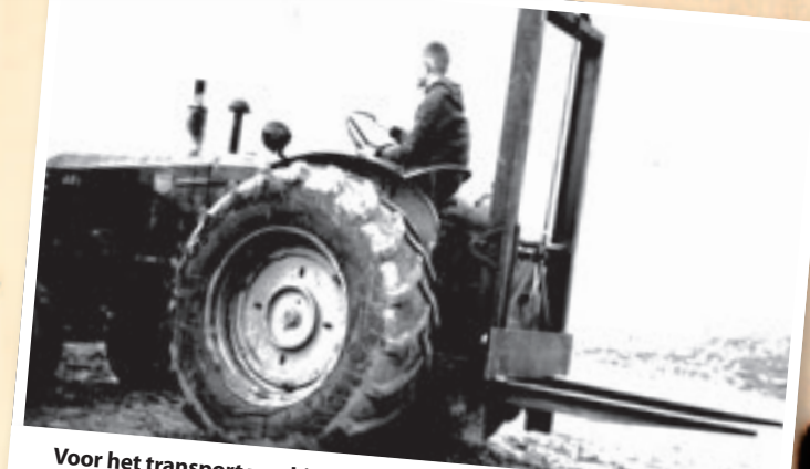
Voor het transport van kisten maken de heren Wijk en Vink uit Uithuizen een mechanische vorkhefmast. Heffen en laten zakken gebeurt met een lier en een set tandwielen met een zelfremmende worm.
