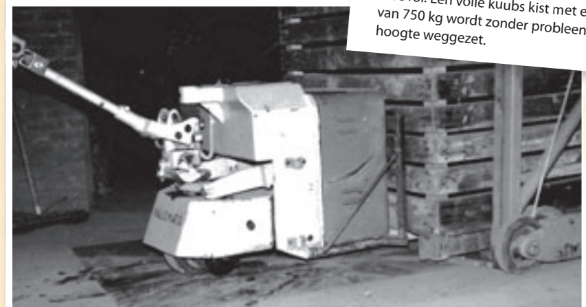
Om een kist in een kistenkantelaar te plaatsen is de elektrisch aangedreven hefwagen een uitstekend hulpmiddel. Achter het zwenkwiel zitten enkele accu's. Elektrische aandrijving betekent geen lawaai en geen productie van schadelijke uitlaatgassen.
