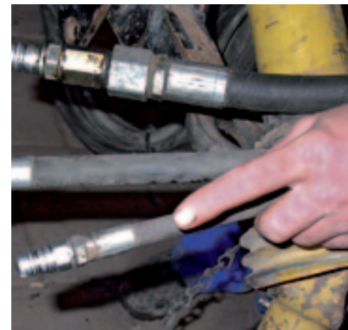
▲ Door de verschillende maatvoering is foutief aansluiten onmogelijk.
