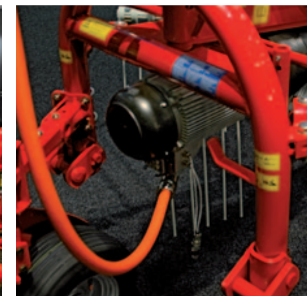
Pöttinger liet op de Agritechnica deze proefballon op: de koppelingsas van de hark is vervangen door een elektromotor.
