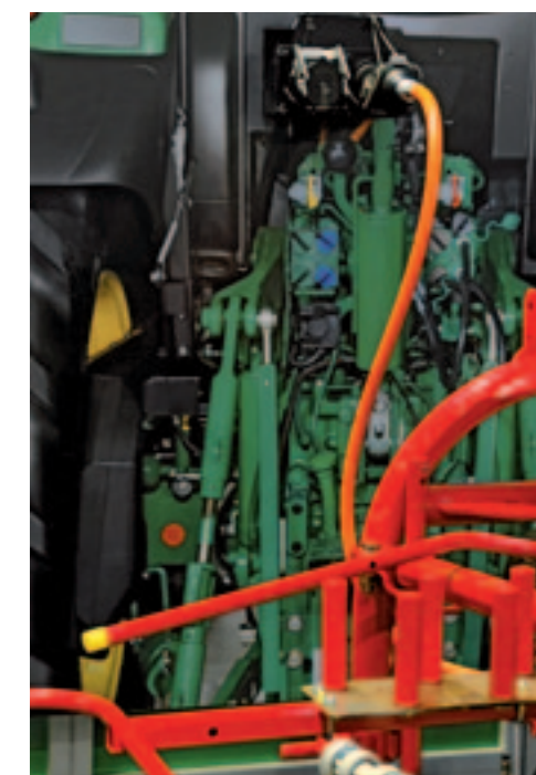
Pöttinger liet op de Agritechnica deze proefballon op: de koppelingsas van de hark is vervangen door een elektromotor.
