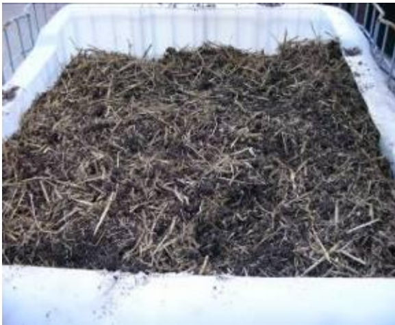
Foto 22: Biomix is een mengsel dat uitspoeling tegengaat en is een goede voedingsbodem voor bacteriën en schimmels
