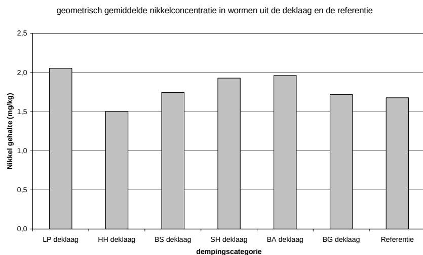
Figuur 4.6d Geometrisch gemiddelde nikkelgehalten in wormen uit de deklaag en referentiemonsters; veldinventarisatie. Geen PIMM gegevens voorhanden.
