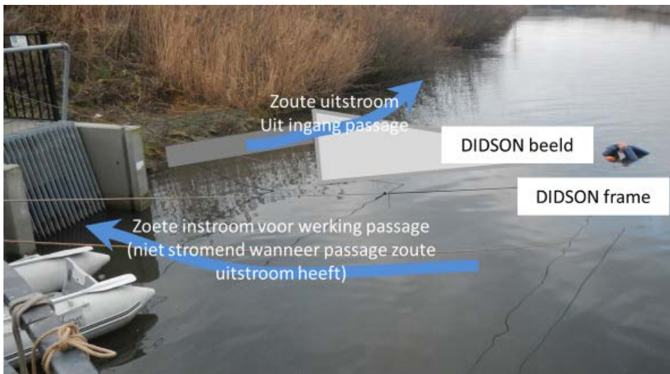
Figuur 6. Opstelling van de DIDSON (hangend in een drijvend frame). De bundel van de DIDSON is gericht op de ingang van de passage voor uittrekkende vis.
