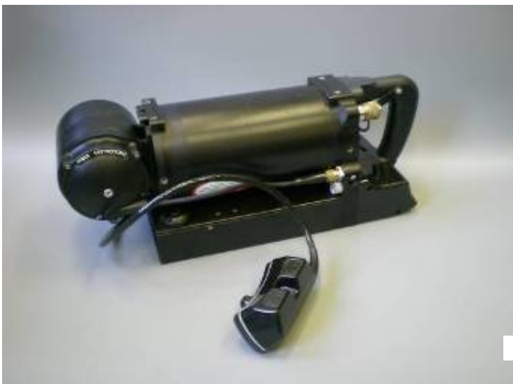
Figuur 5. De DIDSON (L 43 cm x B 20 cm x H 17 cm) (links) en de beeldhoek van de DIDSON (rechts).
