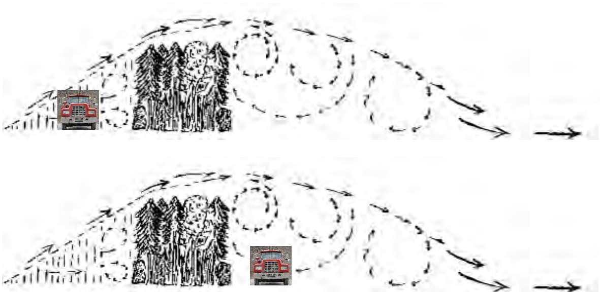
Figuur 3. Schematische weergave van de stroming rond een dicht groenelement met een emissiebron, de vrachtauto, aan de windzijde (boven) en in de luwte (onder) van het groenelement.
