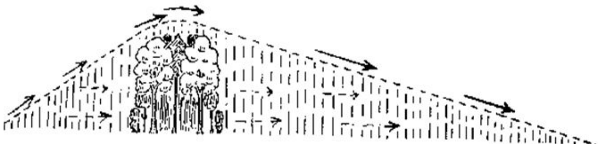
Figuur 2. Schematische weergave van de stroming rond een doorlatend groenelement zonder emissiebron.
