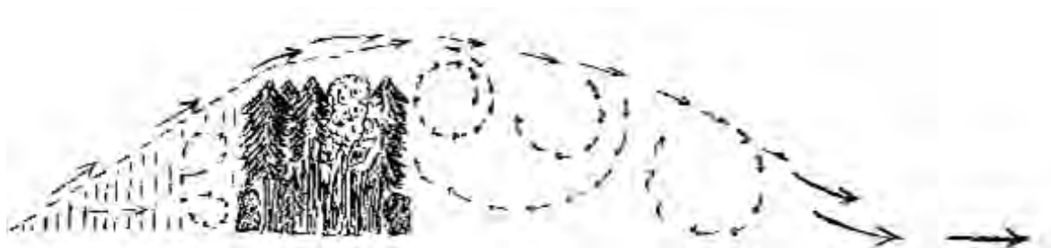
Figuur 1. Schematische weergave van de stroming rond een dicht groenelement zonder emissiebron.
