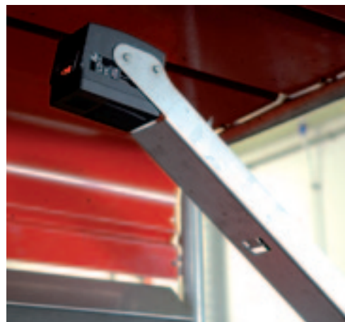
Een 3D-camera boven de koe herkent het kruis. Aan de hand daarvan weet het melksysteem waar het uier van de koe zich bevindt.
