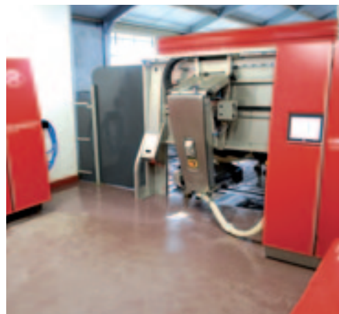
De Astronaut A4 bestaat uit een centrale unit waarop je één of twee melkboxen kunt aansluiten.
