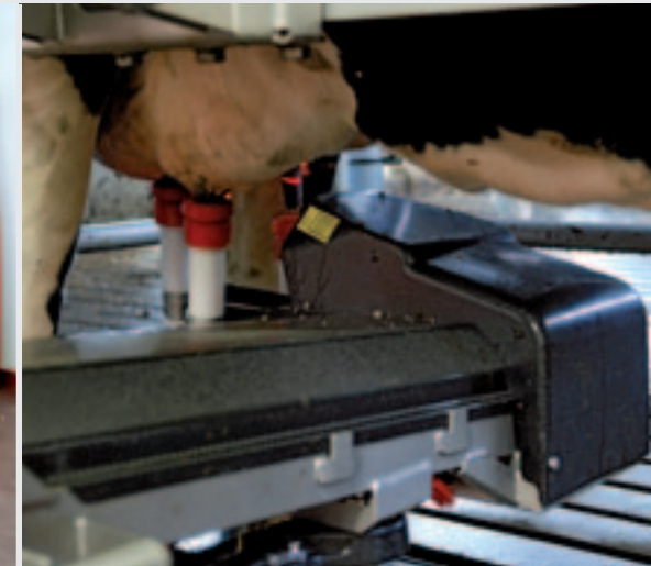
De robotarm van Lely's melkrobot is voorzien van een camerasysteem dat de spenen zoekt.
