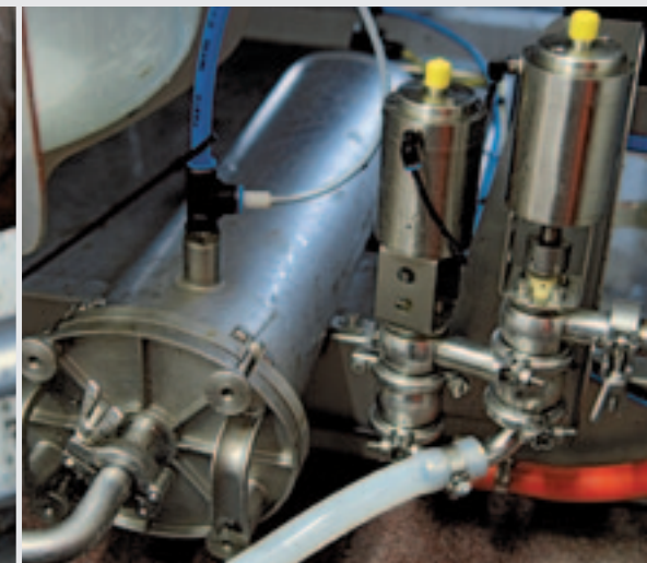
De pomp van A4 is niet voorzien van rotorbladen. Daardoor worden vetbolletjes niet kapot geslagen en blijft het aandeel vrije vetzuren laag.
