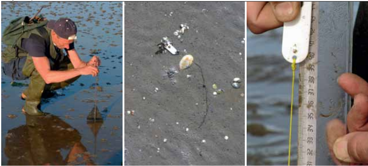
Figuur 2 Vanaf een grondanker loopt een sterke, niet rekbare kunststofdraad naar het wadoppervlak. Het stuk draad dat boven het wad uitkomt kan eenvoudig opgemeten worden. Wanneer er sedimentatie plaats vindt steekt de draad minder ver uit het wad, als er erosie is wordt het bovengrondse stuk langer.
