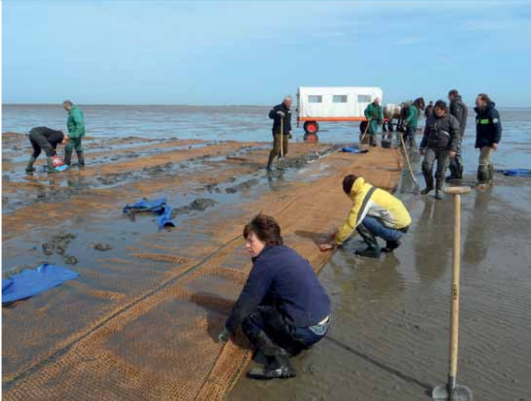
Een proefvlak wordt met kokosnet bedekt.
