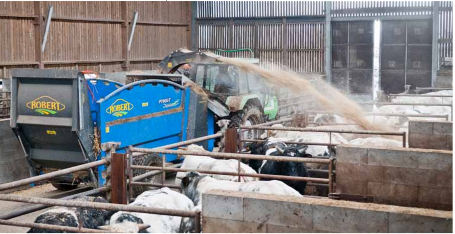
De nieuwe strobblazer zorgt voor een lagere arbeidsdruk en kan ook als mengvoerwagen worden ingezet
