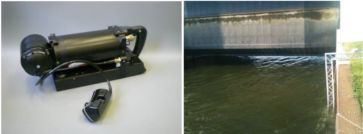
Figuur 2 De DIDSON (links) (L 43 cm x B 20 cm x H 17 cm) en het frame waaraan de DIDSON van de kant af in het water is gehangen (rechts).
