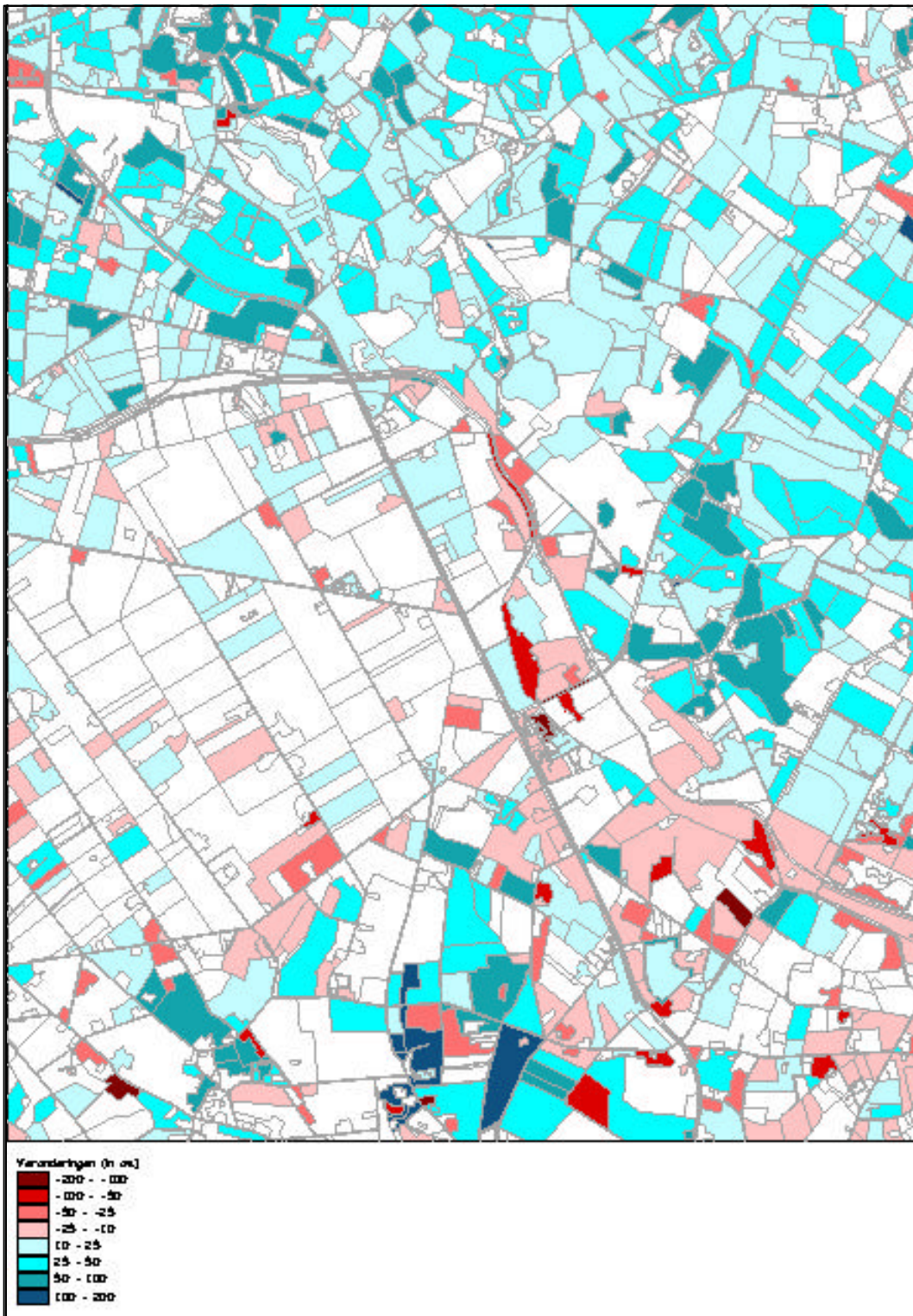
Figuur 14: Methode 2. Gemiddelde veranderingen in hoogte van het maaiveld per vlak uit de TOP-10 tussen de tijdstippen 1967 en 1996
