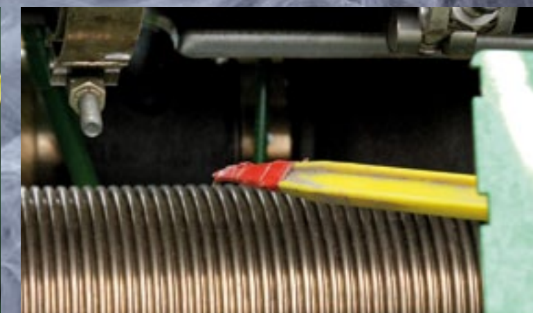
▲ In het uitlaatsysteem is een verbingsstuk opgenomen om de expansie van de uitlaat op te vangen. Naast de expansie vangt deze ook de trillingen op.
