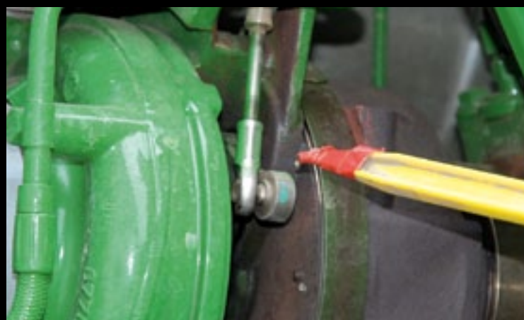
▲ In het midden van de turbo is de stang zichtbaar die de klep aanstuurt waardoor de opbrengst van de turbo variabel wordt. De klepverstelling wordt aangestuurd op basis van de hoeveelheidsmeting die in het systeem is geplaatst.
